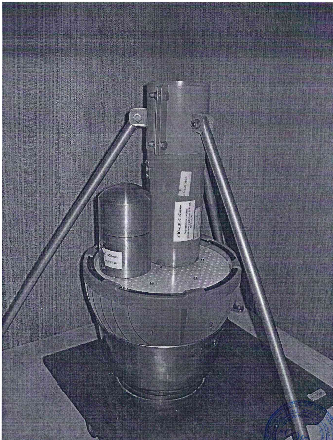
Рис. 5. Вид на вертикальное ударное устройство ВУУ-10 с ударником D-80 мм перед испытаниями на ИК 09
